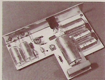
Bild 11. Elektronisch stabilisiertes Netzteil; a) Einzelteileanordnung, b) fertiger Baustein
