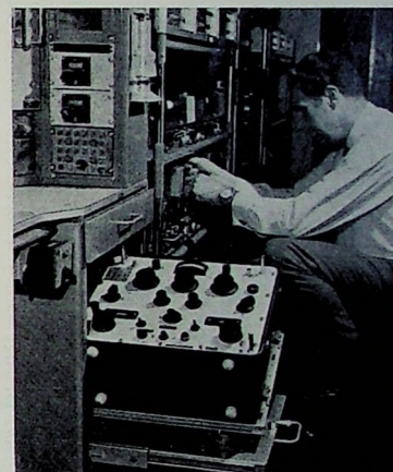
In der ausgezogenen Schublade befindet sich der Corsor-Meßsender „CRM 555“, der während des Fluges für Tests die beim ILS- oder VOR-Anflug empfangenen Signale erzeugt
